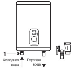
Рис. 1 1. Предохранительный сливной клапан.
