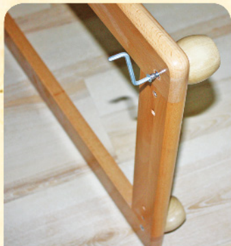
1. Соединить опоры с дном комфирматом
