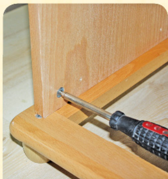
4. Зафиксировать бока эксцентриком
