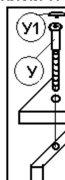
**Примечание:** изделия набора после сборки соединить между собой межсекционной стяжкой комплект №12, предварительно просверлив под нее отверстия диаметром 8мм.
