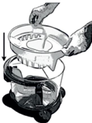
7. Поставьте моторный отсек на место и зафиксируйте его.
