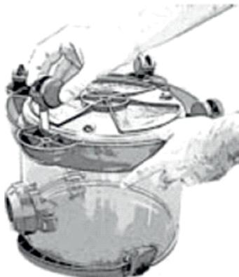
5. Вставьте трубку водяного фильтра.
