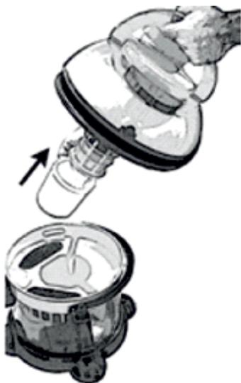
5. Снимите бак для сбора мусора и наполните емкость водой (до 2,5 л).
