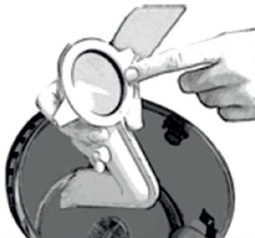
7. Поставьте корпус водяного фильтра на место и зафиксируйте его.
