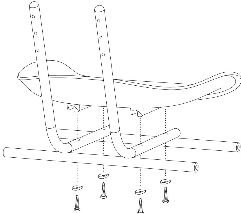
При помощи саморезов и пластиковых шайб закрепите сиденье к соответствующим местам на стальном каркасе. Для этого вам понадобится крестовая отвертка.
