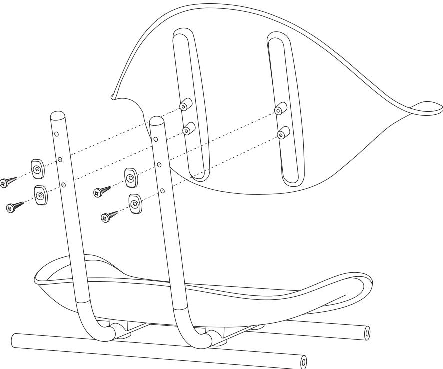
Используя саморезы, пластиковые шайбы и крестовую отвертку закрепите спинку к соответствующим местам на стальном каркасе.
