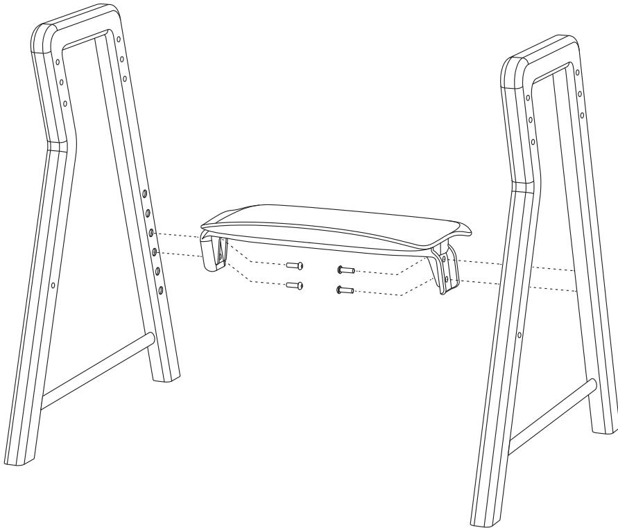
При помощи шестигранных винтов **A** закрепите подножку, соединив обе деревянные опоры на одном уровне. Для этого в комплекте присутствует шестигранный ключ.
