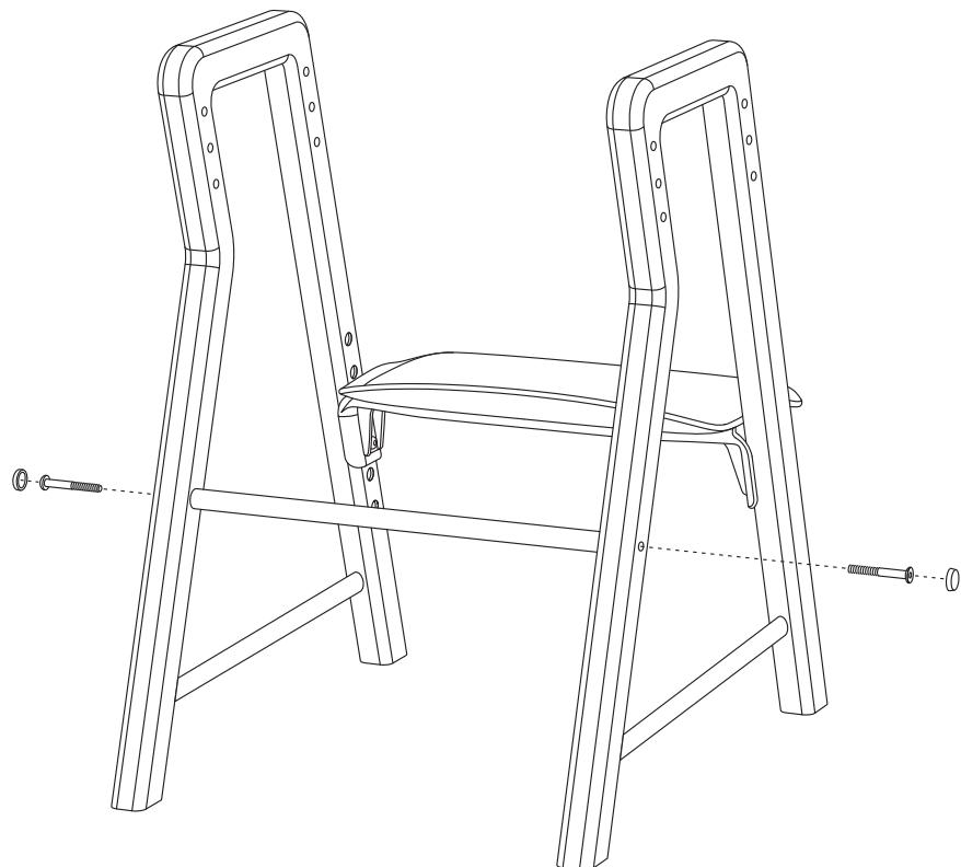
Скрепите деревянные опоры стяжкой при помощи шестиграных винтов **В** к соответствующим местам на ножках, как показано на рисунке. Установите пластиковые заглушки.
