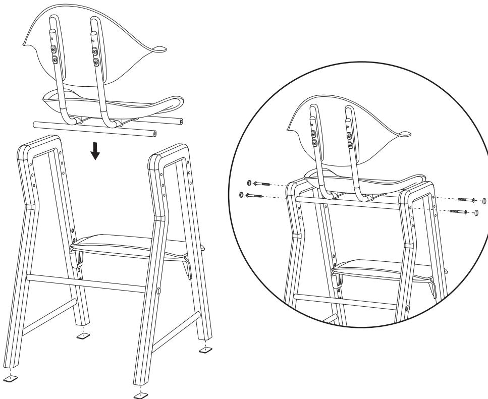
Установите собранный каркас с сиденьем и спинкой, закрепив с помощью шестиграных винтов **В** на одном уровне, как показано на рисунке. Установите пластиковые заглушки на шестигранные винты **В**. При необходимости прикрепите фетровые накладки на ножки стула.
