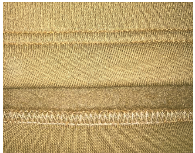
Широкая распошивальная двухигольная строчка (сверху лицевая сторона строчки, снизу изнаночная сторона строчки)
