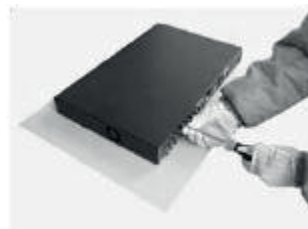
8) Зафиксируйте крышку винтами
