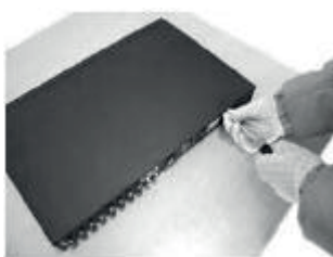
1) Открутите винты, фиксирующие крышку
