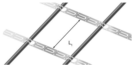
Шаг укладки кабеля на монтажной ленте
