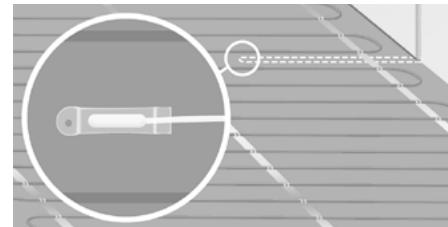
**9.2.** В случае установки датчика температуры пола (входит в комплект терморегулятора CALEO) в гофротрубку, датчик поместите в гофротрубку, заглушенную на одном конце для предотвращения попадания внутрь влаги. Датчик температуры должен быть расположен на расстоянии 50–100 см от стены и гофротрубка зафиксирована на монтажной ленте.
