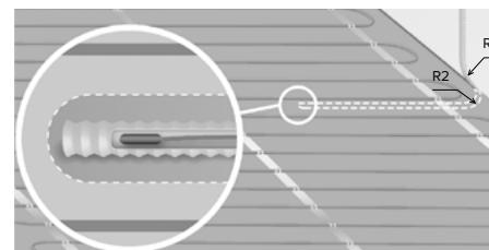
**9.3.** Чтобы обеспечить свободное перемещение термодатчика в трубке (возможность замены в процессе эксплуатации), рекомендуем при переходе от стены к полу выполнять два больших радиуса изгиба трубы в двух плоскостях.
