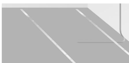
**7. Определите шаг укладки нагревательного кабеля** по общей длине кабеля по формуле:  $H=(Sx100)/L$  (см, где S — площадь укладки, м<sup>2</sup>; L — длина нагревательного кабеля, м).
