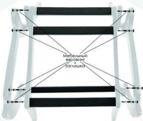
Скрутите боковины механизма качания и четыре поперечные планки четырьмя мебельными евровинтами с каждой стороны.
