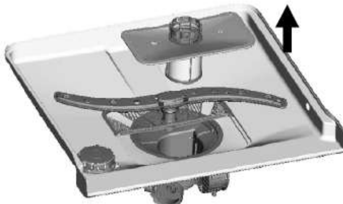
Шаг 2: Выньте фильтр движением вверх
