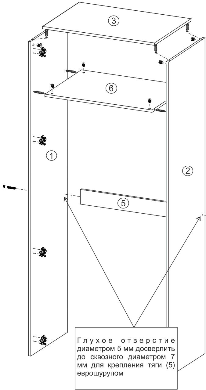
5. К боковинам 1 и 2 прикрепить крышку 4 при помощи еврошурупов. Затем установить ножки, используя шурупы 4\*30 мм.
