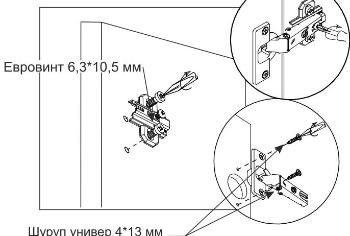
Регулирование зазоров и положения дверей с петлями
