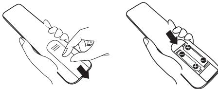
Замените батарею, когда ее напряжение снизилось, ограничивая область действия ПДУ. Не используйте вместе батареи разных типов (например, марганцевые и щелочные).
