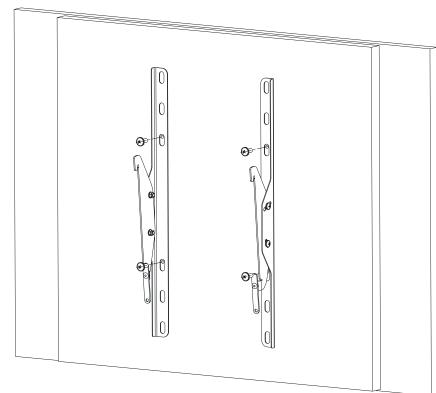
**Увага!** Після встановлення кронштейну перевірити надійність його кріплення до панелі телевізору.
