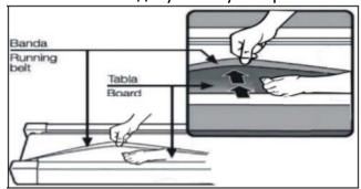
• Включите дорожку на минимальной скорости и в течение 5 минут походите, смещая шаг справа налево и в обратном направлении относительно ширины деки так, чтобы смазка как можно равномернее распределилась по всей ее поверхности.
