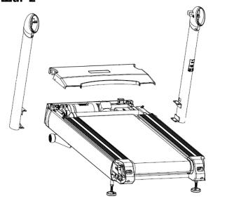
Установите передние стойки консоли и закрепите при помощи четырех болтов.
