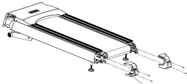
Установите задние заглушки и закрепите их с помощью двух винтов.
