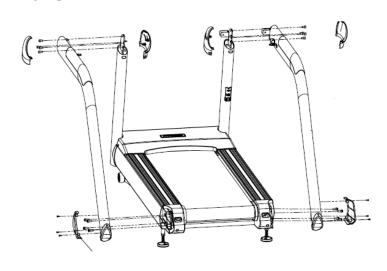
Установите задние стойки консоли и закрепите их с помощью 8 болтов, как показано на рисунке.
