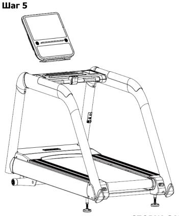
Установите консоль на операционную панель и закрепите с помощью четырех винтов, как показано на рисунке.
