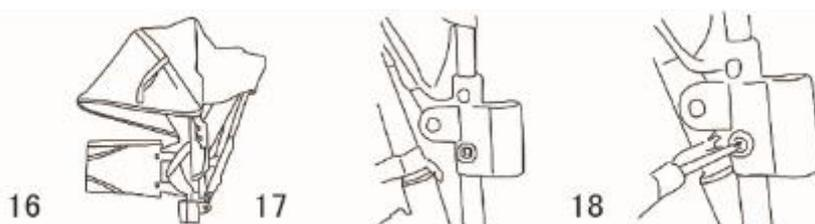
Шаг 9. Установка ограждения: достаньте ограждение, затем поместите в пластиковую выемку и закрепите ограждение.
