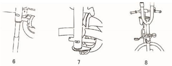
Шаг 5. Установка защитных ограждений: сначала раскрутите винты на спинке сиденья. Достаньте винт, поместите его на защитное ограждение и овальную трубу на каркасе. Не затягивайте винт на гайке, после наводки отверстия на ограждении и раме закрутите винты, затяните снова и затем затяните гайку.
