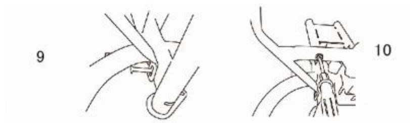
Шаг 6. Установка сиденья: сначала поместите два винта на сиденье, открутите гайку (в соответствии с ростом ребенка) в отверстиях, затем вставьте винты и закрутите.
