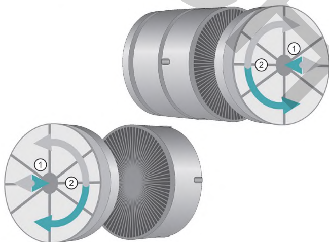
Рис. 14 Установка угольного фильтра
