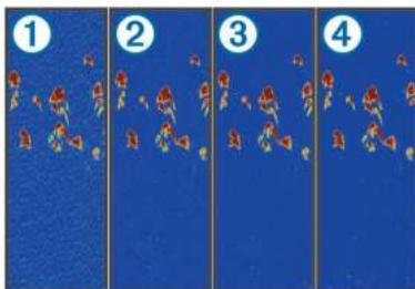
При последовательной установке значения ①, соответствующего выключенному состоянию, минимальной ②, средней ③ и максимальной ④ уровнем шума постепенно снижается, но это практически не влияет на сильные эхосигналы, отраженные от целей. Для удаления помех с экрана следует использовать настройку, максимально снижающую помехи и улучшающую изображение. Чтобы
