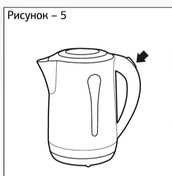
Рисунок – 5 — Перед снятием с базы убедитесь в том, что чайник выключен (переключатель в положении 0).
