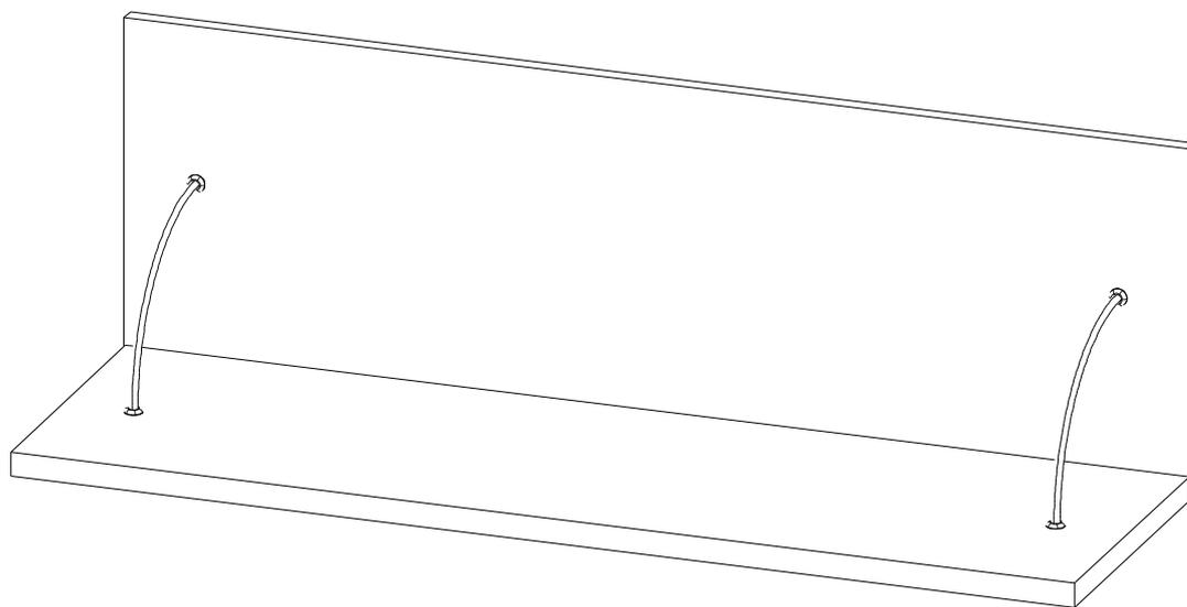
После сборки необходимо повесить полку на стену. Просверлите 2 отверстия  $\varnothing 6$  мм и глубиной 50 мм. Расстояние между осями отверстий должно быть 800 мм. Забить в отверстия дюбель и вкрутить шурупы.
