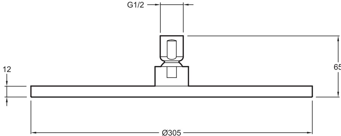
Спецификация продукта: Круглый верхний душ, диаметр 305 мм, современный дизайн. E13690. Коллекция: KATALYST. РАЗМЕРЫ (СМ): 30 x 30 см. ВЕС: 2,7 кг. АКСЕССУАРЫ: ВЕРХНИЙ ДУШ. НАЛИЧИЕ СМЕСИТЕЛЯ: 0. ОДНОРЫЧАЖНЫЙ СМЕСИТЕЛЬ: 0. КЛАССИФИКАЦИЯ: 0. ФОРМА ВЕРХНЕГО ДУША: 0. ТИП СИСТЕМЫ: С СИСТЕМОЙ MODULO. ПЕРЕКЛЮЧАТЕЛЬ: 0. ТИП ШЛАНГА: 0. Вращающийся верхний душ, антиизвестковое покрытие.
