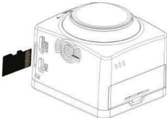
**Примечание:** Камера не оборудована встроенной памятью, пожалуйста, установите карту памяти формата microSD перед использованием камеры. Отформатируйте карту памяти в камере через настройки.
