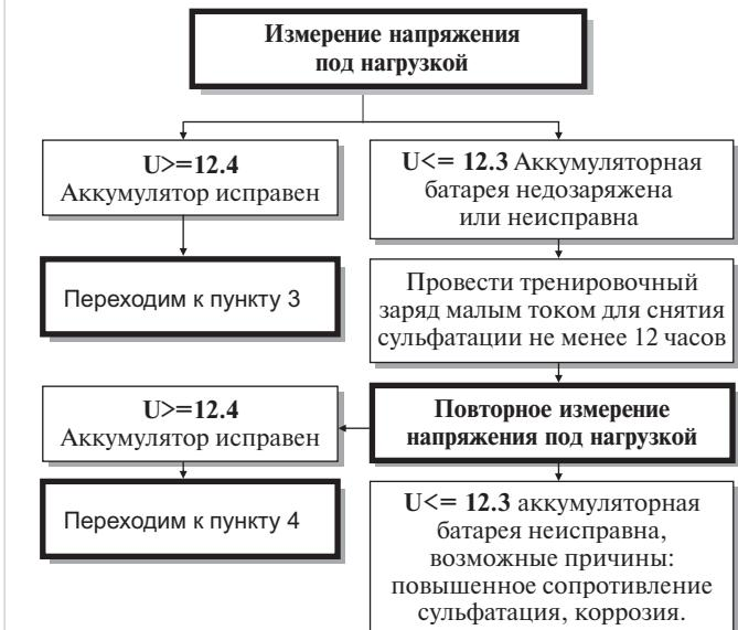
**Пункт 4.** Проверка аккумуляторной батареи Электронной нагрузочной вилкой, в качестве нагрузки используется стартер. (Батарея заряжали в пунктах 2 или 3.)
