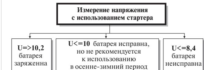
\*\* Для корректного измерения параметров необходимо производить измерения не ранее чем через 30 минут после выключения двигателя.
