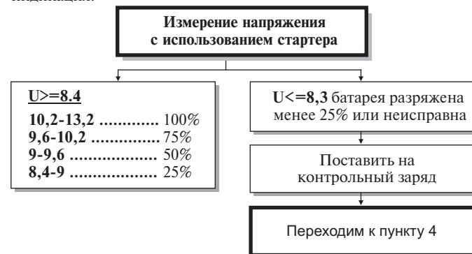
**Пункт 2.** Проверка аккумуляторной батареи слаботочной нагрузкой.
