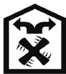
в режиме рециркуляции (замкнутой круговой циркуляции воздуха на кухне), когда вытяжка не подключается к дымоходу, а воздух прогоняется через жироулавливающий алюминиевый (в комплекте) и запахопоглощающий угольный (покупается отдельно) фильтры и возвращается обратно в кухню (рис.2).
