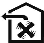
в режиме отвода воздуха в стационарный вентиляционный шахту (дымоход) кухни с использованием гофрированных алюминиевых или пластиковых воздуховодов Ø150 x Ø120мм (рис.1);
