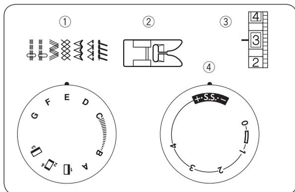
Если подача ткани вперед или назад становится несбалансированной из-за типа ткани, отрегулируйте баланс при помощи регулятора длины стежка:
