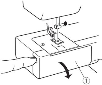
Поверните маховое колесо на себя и поднимите иглу. Вытащите шпульный колпачок за язычок.
