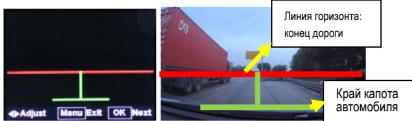
Настройка: кнопками UP (▲), DOWN (▼) настроить линию горизонта. Далее нажмите кнопку OK, чтобы перейти к регулировке следующей линии. По завершении калибровки нажмите кнопку OK для сохранения настроек и выхода. Для отмены калибровки и возврата в меню нажмите кнопку MENU (☰).
