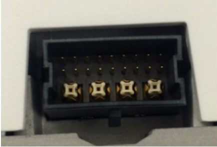
Рисунок 8 Интеллектуальный разъем антенны на модели 2802E
