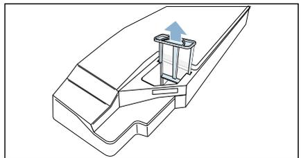
11. Вставьте фильтр в углубление резервуара для конденсата.
