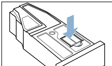
12. Задвиньте резервуар для конденсата до фиксации.
