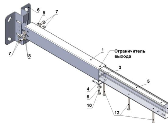
Соберите штангу, как показано на рисунке 4. Для этого соедините винтами M5 с шайбами основание (6) и внешнее колено штанги (1). Уложите провода внутри внешнего колена штанги. Вставьте внутреннее колено штанги (2) во внешнее колено, предварительно проведя провода и собрав сухарный узел (3, 4, 9, 10). Вставьте заглушку (5) внутрь колена. Ограничитель выхода должен быть со стороны колена и обращен наружу. Зафиксируйте заглушку винтами (12).
