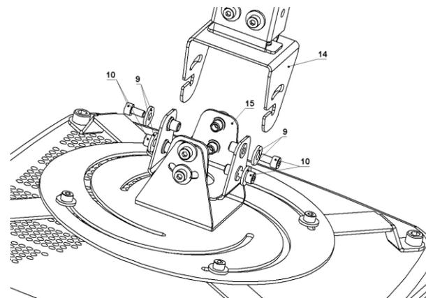
Привинтите крепление (14) с переходником (13) к штанге соосно или перпендикулярно, в зависимости от выбранного способа монтажа кронштейна (на потолок или на стену). Если монтаж осуществляется без штанги, привинтите крепление (14) с переходником (13) к основанию (6). Прикрепите собранный кардан к проектору, используя подходящие винты и шайбы из комплекта поставки.
