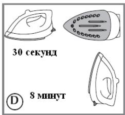
Үтікті автоматты сөндіру функциясы келесідей тәсілмен жүзеге асады: Белгілі бір температураға дейін қыздырылған, бірақ, қолданылмаған үтік, сондай-ақ, табанында жатқан немесе бір қырынан жатқан үтік 30 секундтан кейін автоматты түрде сөнеді. Егер үтік пайдаланылмаса және таяныштірекti тігінен тұrsa, - автоматты түрде сөну режимі 8 минуттан кейін қосылады ( D сурет). Үтік автоматты түрде өшкен кезде дыбыстық сигнал естіледі.
