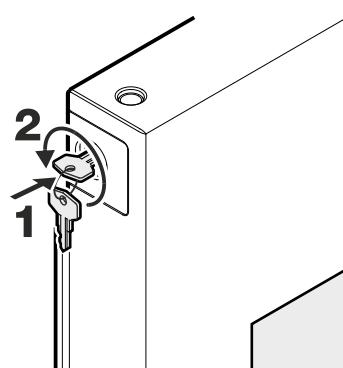
Чтобы отпереть прибор, поступайте в такой же последовательности. Поверните ключ по часовой стрелке.
