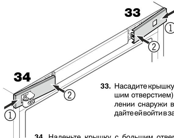
34. Наденьте крышку с большим отверстием на шарнирный уголок в направлении снаружи вовнутрь и дайте ей войти в зацепление.
