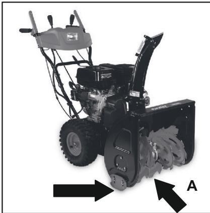
Перед началом работы необходимо отрегулировать опорные лапы. Для предотвращения поломки шнека высоту опорных лап регулируют так, чтобы пластина А находилась над фунтом не менее 1см.
