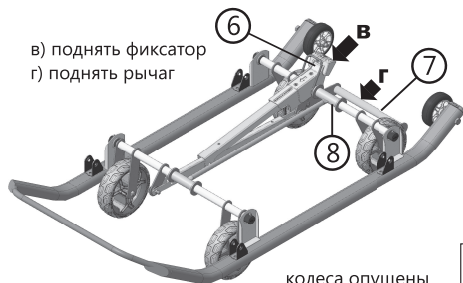
рис. 2 Механизм выдвигающих колес
