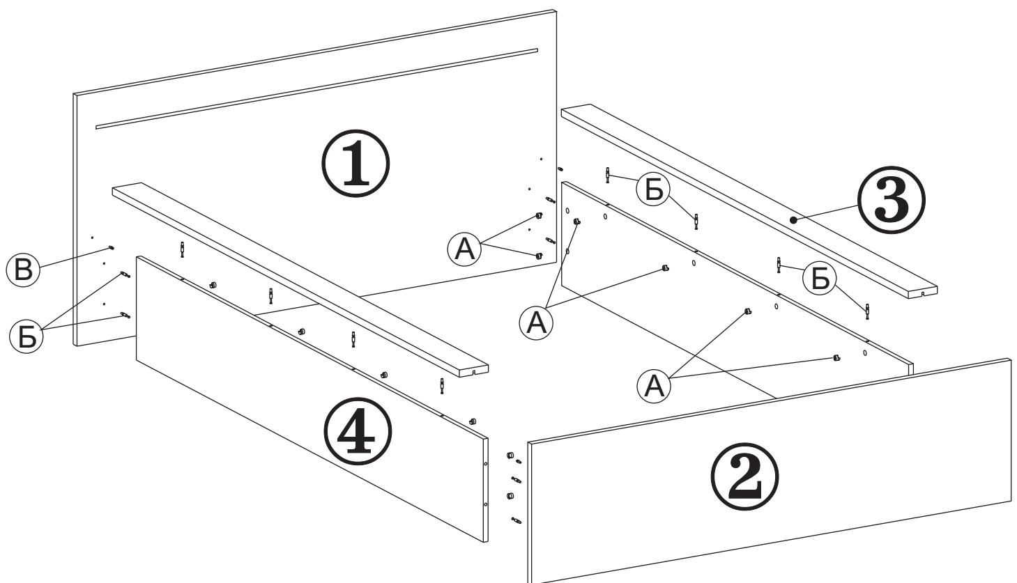
1. В отверстия в спинках закрутите штоки эксцентриков и ввинчивающиеся дюбели. В отверстия в полках закрутите штоки эксцентриков. В отверстия в царгах вставьте эксцентрики. Стрелка на эксцентриках должна быть направлена к торцу детали. На нижних торцах спинок закрепите гвоздями наконечники.
