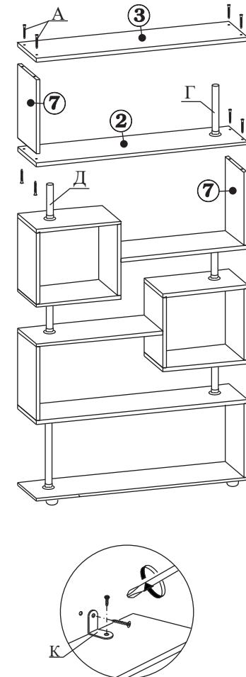
3.5. Присоедините и закрепите последовательно оставшиеся детали №2, №7 и №3, а так же трубу (поз.Г).
