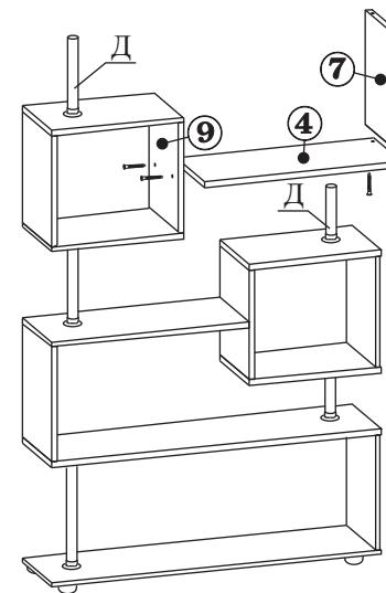
3.4. Аналогичным образом присоедините и закрепите второй короб. Следите чтобы трубы входили в штангодержатели и не забывайте фиксировать их стопорными винтами.
