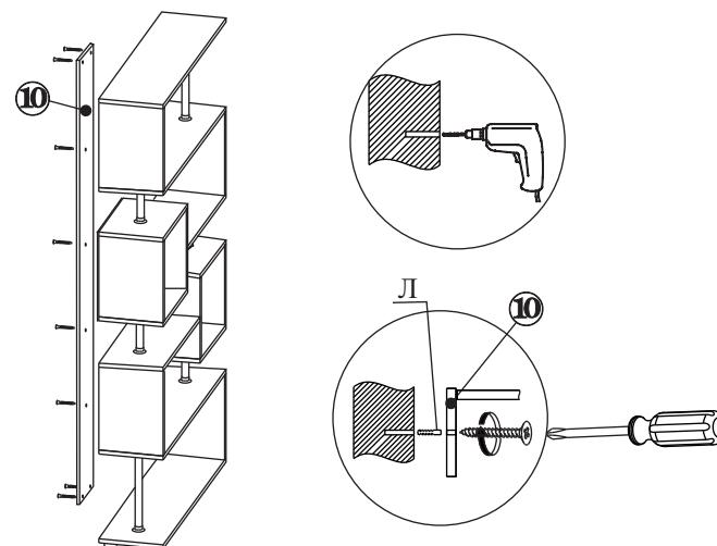
3.6. Разметте и просверлите отверстие в стене, забейте дюбель. Закрепите стеллаж к стене шурупом 4x40 сквозь деталь №10 предварительно просверлив в ней отверстие 5мм или с помощью монтажного уголка.
