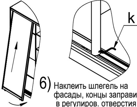
6) Наклеить шлегель на фасады, концы заправить в регулиров. отверстия
