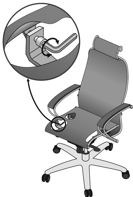
Regolazione bi-zona della rigidità del sedile
