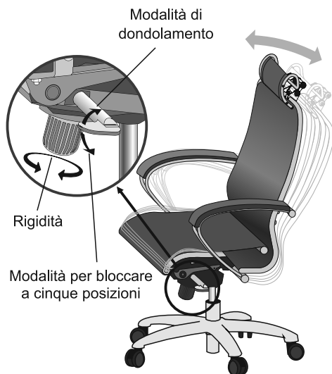
Regolazione d'inclinazione della spalliera e del sedile, rigidità regolabile del meccanismo sincronizzato
