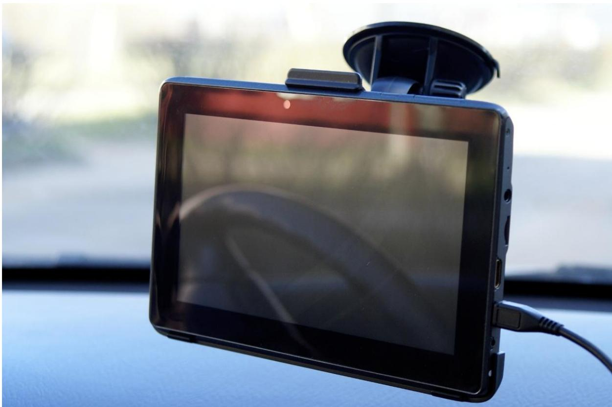
Корпус GeoVision 7777 выполнен из серого пластика, лицевая панель черная, с зеркальным покрытием. Задняя панель рифленая, благодаря чему устройство намного проще держать одной рукой, пальцы не скользят. Навигатор радует качественной сборкой, корпус не скрипит, кнопки отлично подогнаны и нажимаются четко. Данная модель получилась тонкой и легкой – при габаритах 1921239 мм вес составил всего 290 грамм. Для 7-дюймового навигатора это отличные параметры.
