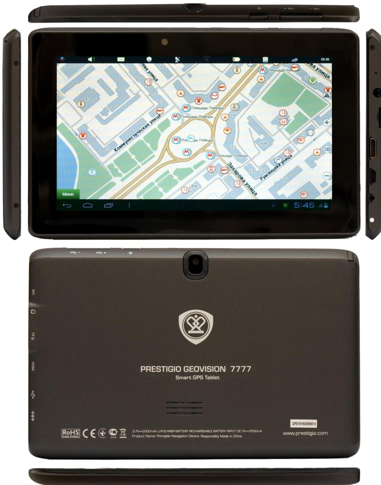
Большую часть лицевой панели занимает цветной 7-дюймовый TFT-дисплей с разрешением 840\*480. GeoVision 7777 порадовал отличными углами обзора по вертикали и горизонтали – цветовых искажений практически не наблюдается. Из-за зеркальной наклейки на лицевой панели экран ощутимо бликует на солнце, но остается читаемым из-за хорошего запаса яркости. Среди автомобильных навигаторов дисплеи с такой качественной картинкой практически не встречаются.
