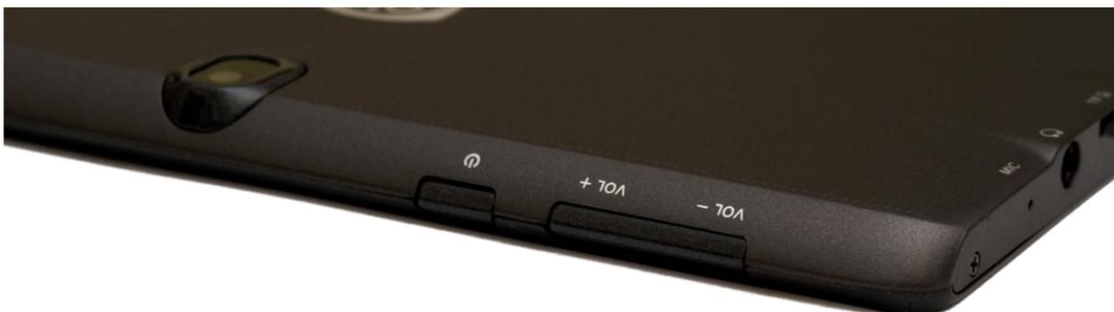
На верхнем торце GeoVision 7777 находятся кнопка включения-выключения устройства и сдвоенная клавиша регулировки громкости. Тут же прячется и телескопическая ТВ-антенна. Как показала практика, она несильно влияет на уровень приема сигнала, поэтому, ее можно не выдвигать вообще.
