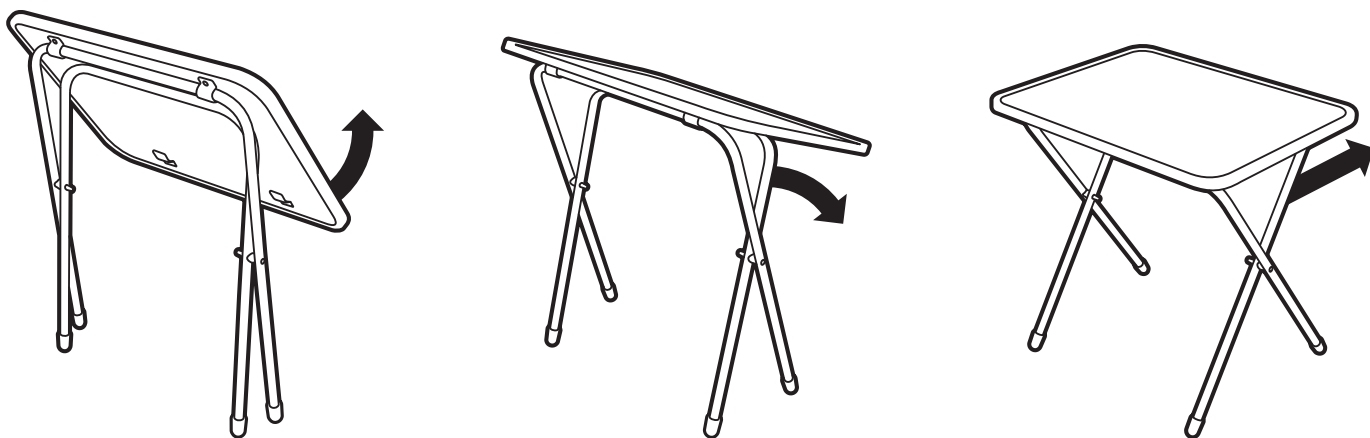
(рис. 3) Схема раскладывания стола (механизм «Познайка»)
