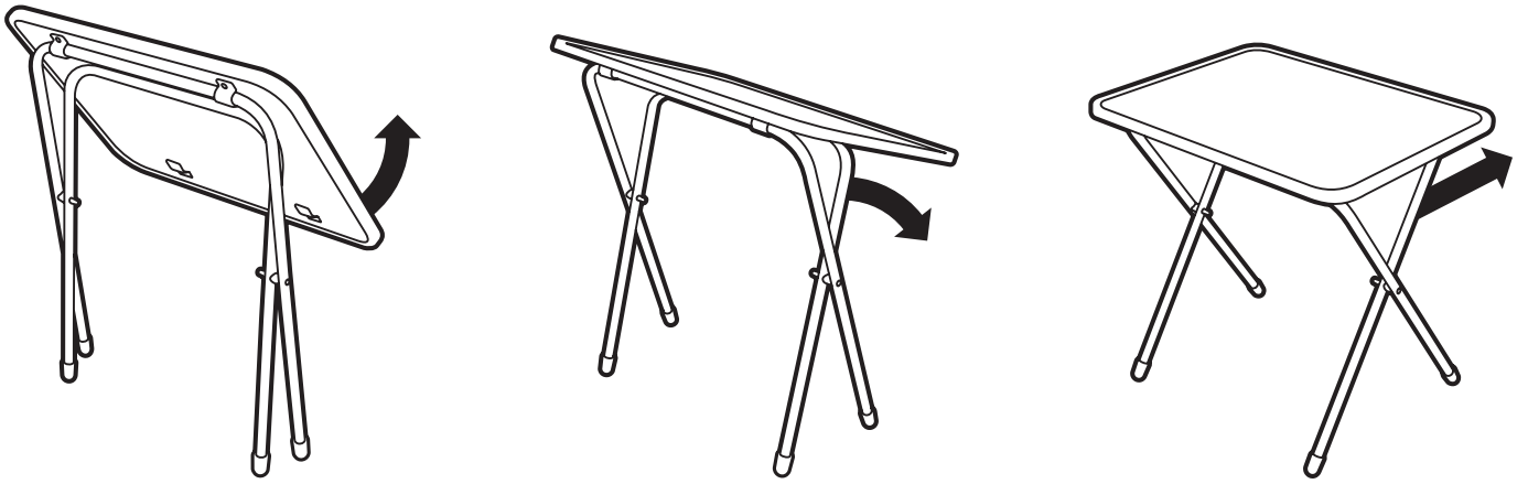
(рис. 2) Схема раскладывания стола
