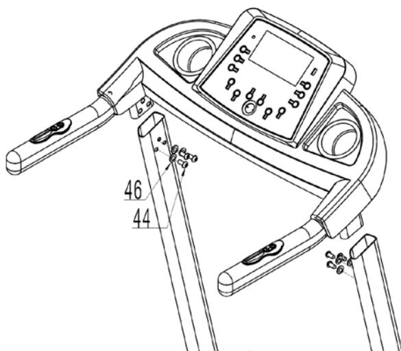
Закрепите консоль на стойках, используя болт M8\*20 (44) и шайбу Ф8 (46).
