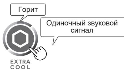
3. Дополнительное охлаждение заканчивается автоматически приблизительно через 6 часов. (Лампа выключится.)
