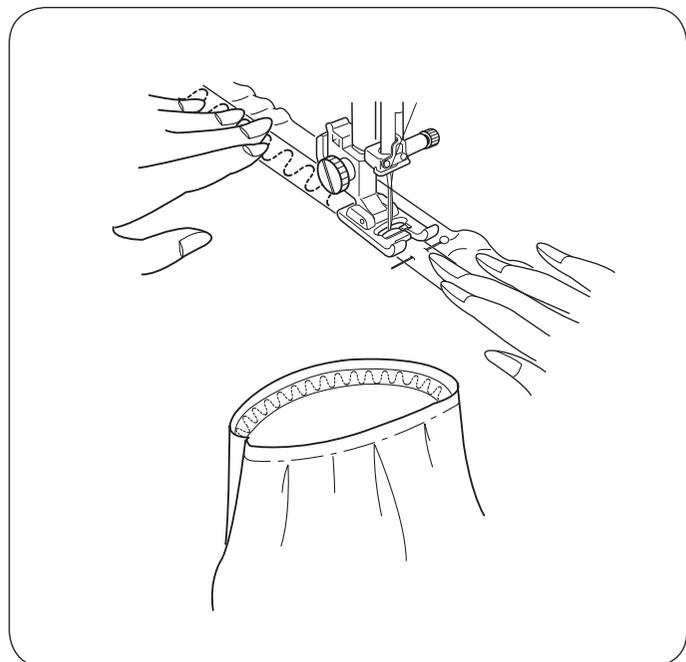
Разделите длину резинки на четыре части и поставьте отметки. Эти отметки совместите с передним и задним швом и с боковыми швами и сколите в этих местах ткань с резинкой.
