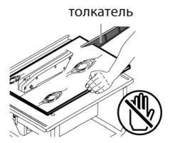
**ВНИМАНИЕ!** Во избежание травм и повреждений оператора не откидывайте кожух (19) диска при подаче заготовки – он откроется автоматически.
