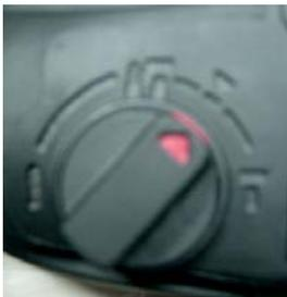
Положение **Vario-Lock** для изменения положения зубила. Вы можете зафиксировать рабочий инструмент в различных положениях. Благодаря этому Вы можете занять соответственно оптимальное положение. Вставьте зубило в патрон.
