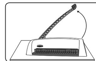
1. Dbajte na to, aby zariadenie bolo na stabilnom povrchu. Zdvihnite perforovacia páčku do zvislej polohy.
