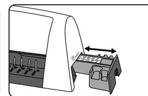
2. Podnieś uchwyt dziurkacza. Sprawdź, czy taca na ścinki jest pusta i poprawnie zamontowana.
