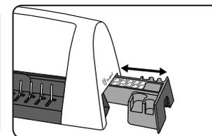
2. Ανασηκώστε τη λαβή διάτρησης. Βεβαιωθείτε ότι το συρτάρι απορριμμάτων είναι κενό και σωστά τοποθετημένο.
