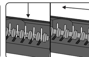
2. Placer le peigne plastique dans le mécanisme d'ouverture et embrayer la plaque d'ouverture en faisant glisser le peigne vers la gauche.
