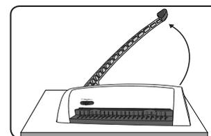
1. Forsikre at maskinen står på et stabilt underlag. Løft hullehåndtaket til hevet stilling.
