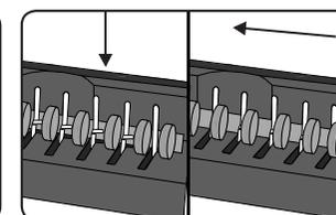
2. Namjestite češalj za uvezivanje u mehanizam za otvaranje i potpuno primijenite ploču za otvaranje tako da povučete češalj ulijevo.
