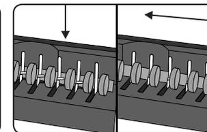
2. Stavite češalj za koričenje u mehanizam za otvaranje i potpuno upotrebite ploču za otvaranje pomeranjem češlja nalevo.
