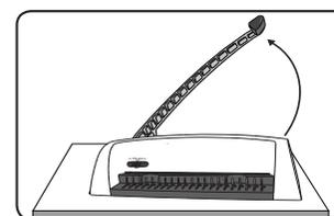
1. Urządzenie należy umieścić na stabilnej powierzchni. Podnieś uchwyt dziurkacza do pozycji pionowej.
