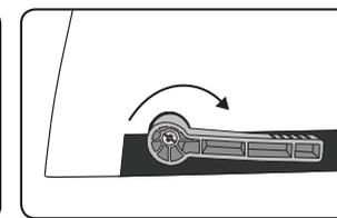
3. Zajistěte, aby byl mechanismus pro otevření hřebene zavřený.
