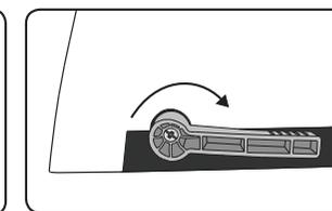
3. Uvjerite se da je mehanizam otvaranja češlja zatvoren.
