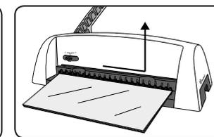
3. Um das Dokument zu entnehmen, schieben Sie den Binderücken nach rechts und heben das Dokument heraus.
