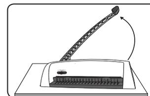
1. Να διασφαλίσετε την τοποθέτηση του μηχανήματος σε μια σταθερή επιφάνεια. Ανασηκώστε τη λαβή διάτρησης στην όρθια θέση.
