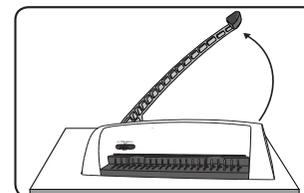
1. Asegúrese de que la máquina se encuentra sobre una superficie estable. Levante el asa de la perforadora hasta su posición vertical.
