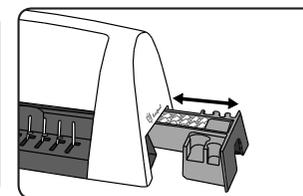
2. Løft hullehåndtaket. Sjekk at avfallsskuffen er tom og korrekt montert.
