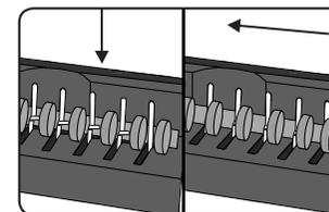
2. Amplasați inelul de îndosariere în mecanismul de deschidere și acționați complet placa de deschidere prin glisarea inelului către stânga.
