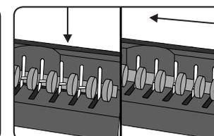
2. Placera bindningskammen i öppningsmekanismen och grip öppningsplattan helt genom att föra kammen till vänster.
