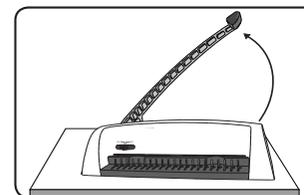
1. Proverite da li je mašina na stabilnoj podlozi. Podignite dršku za bušenje u uspravni položaj.
