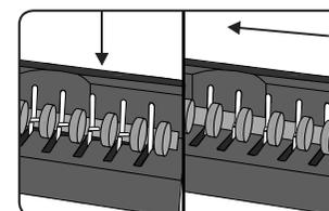
2. Vstavite špiralo za vezavo v mehanizem za odprtje in do konca odprite ploščico za odpiranje tako, da potisnete špiralo levo.
