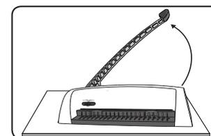
1. Sørg for, at maskinen står på en stabil overflade. Løft udstansningshåndtaget til opretstående stilling.
