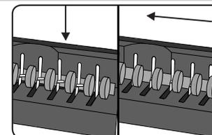
2. Umístěte vázací hřeben do otváračho mechanismu a plně nasadte otvárač pás posunutím hřebene vlevo.
