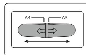
1. Vælg enten A4- eller A5-papirformat, og kontroller maskinens indstillinger ved at stanse kasserede ark. Vælg den korrekte rygdiameter, der passer til dokumentet (se skema).
