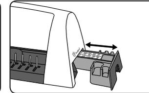
2. Nosta lävistyskahvaa. Tarkista, että silppusäiliö on tyhjä ja paikoillaan.
