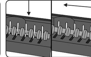
2. Bağlama tarağını açma mekanizmasına yerleştirin ve tarağı sola kaydırarak açma plakasının tam olarak geçmesini sağlayın.
