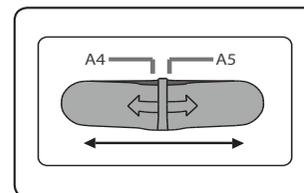
1. Velg enten A4- eller A5-papirstørrelse, og lag hull i prøveark til det blir riktig. Velg korrekt kamdiameter ved hjelp av dokumentmålkortet (se diagram).
