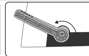
3. Otevřete vázací hřeben otočením páčky hřebene. Postupujte opatrně a neotevírejte hřeben příliš.
