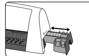
2. Levante a pega de perfuração. Verifique se o tabuleiro de desperdícios está vazio e correctamente encaixado.
