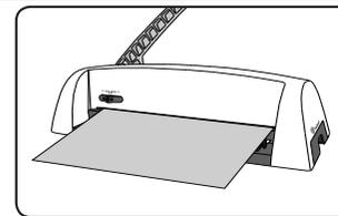
1. Introduceți foile complet în canalul de perforare. Aliniați foile către ghidajul lateral.
