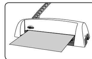
1. Vložte hárky do perforovacieho otvoru. Zarovnajte hárky podľa vodidla okraja.
