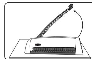
1. Asigurați-vă că aparatul este plasat pe o suprafață stabilă. Ridicați maneta perforatorului în poziția sa verticală.
