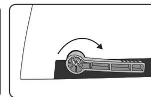
3. Zagotovite, da je mehanizem za odpiranje špirale zaprt.
