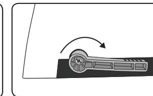
3. Kontrollera att kamöppningsmekanismen är stängd.
