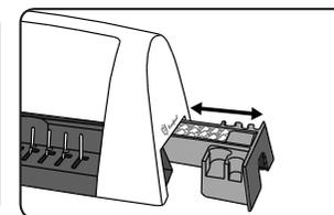
2. Ridicați maneta perforatorului. Verificați dacă caseta de reziduuri este goală și introdusă corect.
