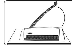
1. Varmista, että laite on vakaalla alustalla. Nosta lävistyskahva pystyasentoon.
