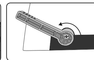
3. Öffnen Sie den Binderücken, indem Sie den Binderückenhebel umlegen. Geben Sie darauf acht, den Binderücken nicht zu weit zu öffnen.
