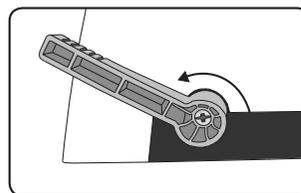
٣. افتح الكعب البلاستيكي الخاص بالتجميع عن طريق خريك ذراع الكعب البلاستيكي. احرص على عدم فتح الذراع البلاستيكي بعيداً.
