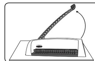
1. Accertarsi che la macchina sia posizionata su una superficie stabile. Sollevare la maniglia per la perforazione in posizione verticale.
