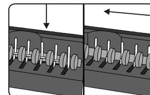
2. Coloque as argolas de encadernação no mecanismo de abertura e accione completamente a placa de abertura fazendo deslizar a argola para a esquerda.
