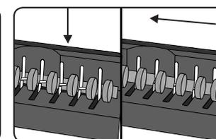
2. Umiestnite viazací hrebeň do otvoru a úplne zacvaknite platňu otvoru posunutím hrebeňa dolava.
