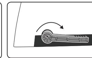
3. Proverite da li je mehanizam za otvaranje češlja zatvoren.
