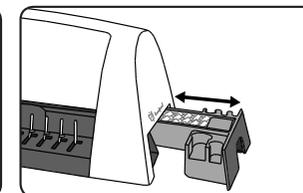
2. Lyft stanshandtaget. Kontrollera att skräpfacket är tomt och korrekt installerat.
