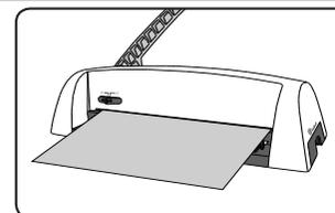
1. Vložte listy zcela do děrovacího otvoru. Zarovnejte listy s vodítkem hran.
