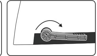
3. Varmista, että kamman avausmekanismi on suljettuna.
