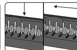
2. Plaats de bindrug in het openingsmechanisme en laat de openingsplaat volledig ingrijpen door de rug naar links te schuiven.
