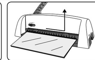
3. Чтобы снять документ, сдвиньте гребенку направо и поднимите сброшюрованный документ.
