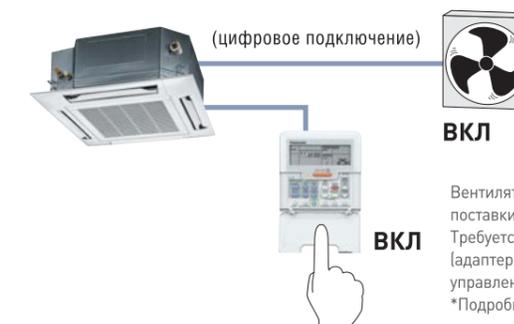
Вентиляторы не входят в комплект поставки. Требуется опциональная печатная плата (адаптер интерфейса внешних сигналов управления) (CZ-TA31P\*). \*Подробности см. на стр. 75.
