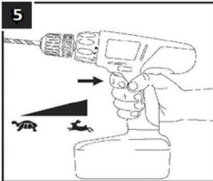
Электронный регулятор оборотов, установленный в Вашем инструменте, позволяет начинать работу при низкой скорости вращения биты/головки. Скорость вращения увеличивается при увеличении давления на выключатель (Рис.5). Для увеличения срока службы инструмента не используйте низкие обороты для выполнения основной работы.
