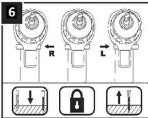
Реверсивный переключатель направления вращения (2; рис.1) позволяет установить направление вращения патрона, а также служит для блокировки случайного пуска инструмента. Центральное положение переключателя блокирует включение аккумуляторной дрели.
