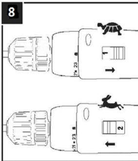
Механическая регулировка скоростного режима позволяет настроить инструмент в соответствии с условиями работы. Вы можете установить низкий скоростной режим с высоким крутящим моментом для работ с крепежом или высокий скоростной режим – для выполнения сверлильных работ.
