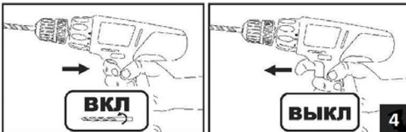
**ВНИМАНИЕ!** Перед тем, как поставить аккумулятор в инструмент, всегда проверяйте, что выключатель исправен и возвращается в положение «Выкл», если его отпустить.
