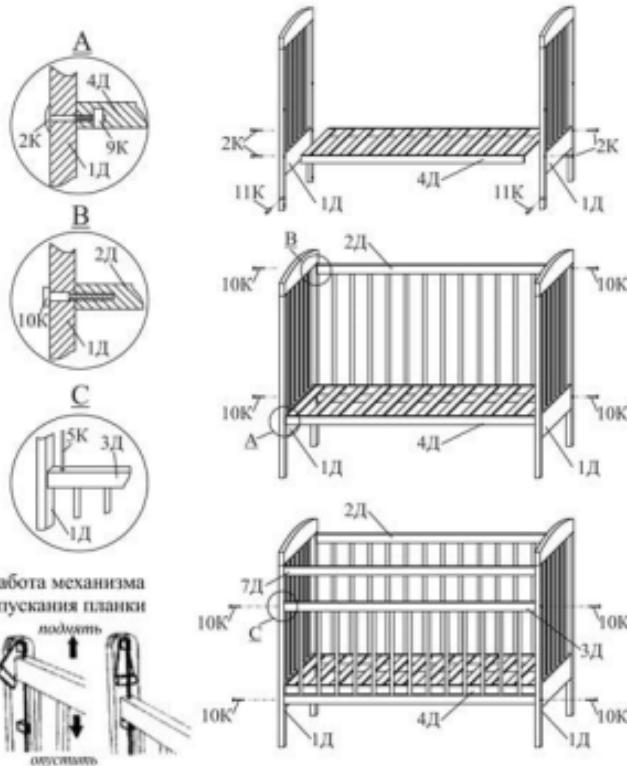
**Внимание!** На одной из продольных планок детали 3Д имеются отверстия под направляющие механизма опускания планки 5К. Они должны быть направлены вверх (как показано на выноске С).
