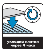
укладка плитки через 4 часа
